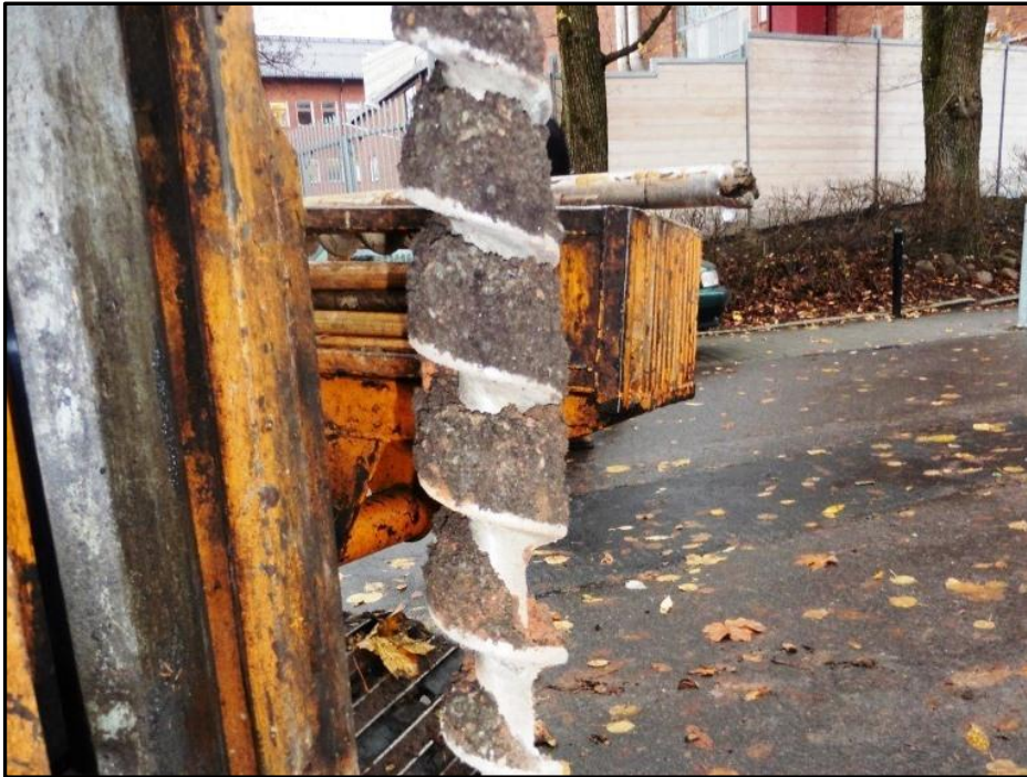
Figur 3. Fyllnadslager i NC9 (1,0 - 1,3 m) som innehöll ett stort inslag av tegelbitar.
